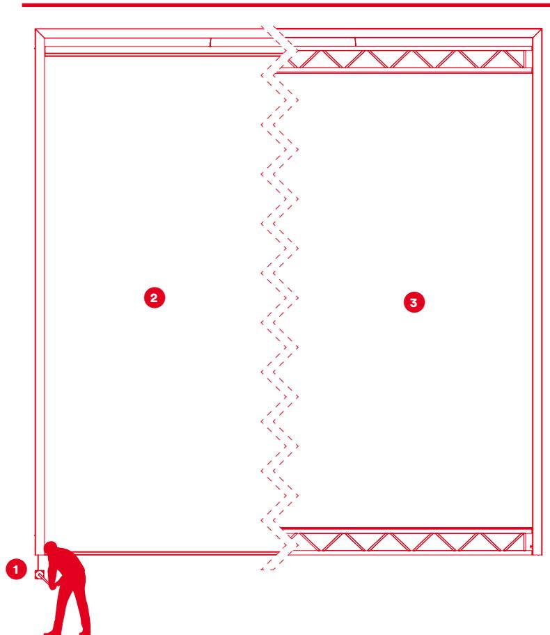
Mittels Handkurbel lässt sich das Megaposter montieren und austauschen. Die Horizontalspannung wird dabei durch einen Gummizug erzeugt, die Vertikalspannung durch das Kurbeln. Die ideale Wahl bei häufigem Sujetwechsel.
