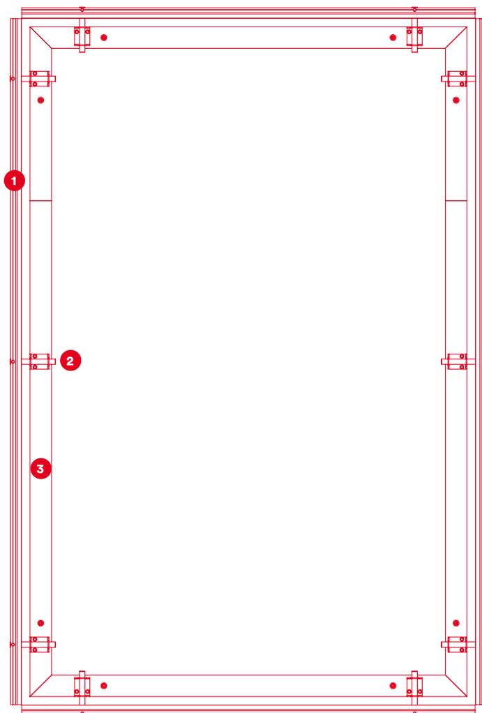
An die Blachen- oder Gitternetzmaterialien werden umlaufend Kederfahnen angeschweisst. Das konfektionierte Megaposter lässt sich so einfach in das Kederprofil einfahren und spannen.
